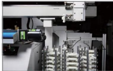
▶ Манипулятор робота портального типа и большой склад не только реализует автоматическое производство, но и повышает ценность станка.
