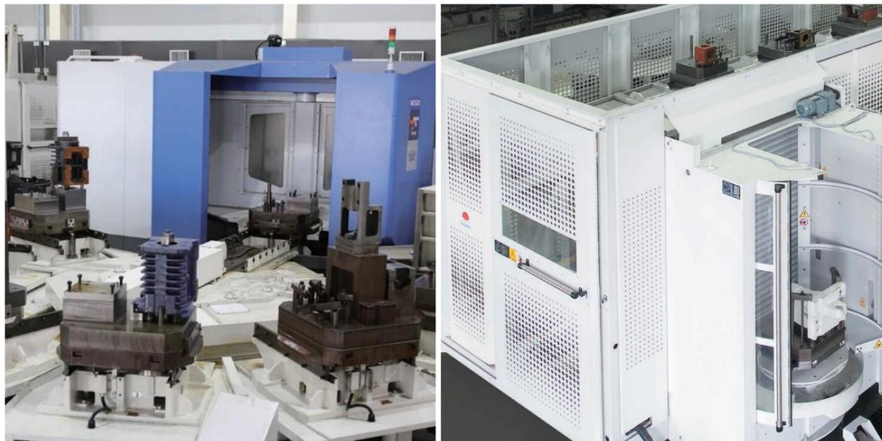
Для обработки ключевых компонентов мы используем 30 различных типов обрабатывающего оборудования, включая 5-осевые обрабатывающие центры, вертикальные фрезерные станки, горизонтальные расточные и фрезерные станки, горизонтальные обрабатывающие центры, вертикальные обрабатывающие центры и токарные станки с ЧПУ. Для этих машин более 50% машин собирается компанией Тонгтай.
