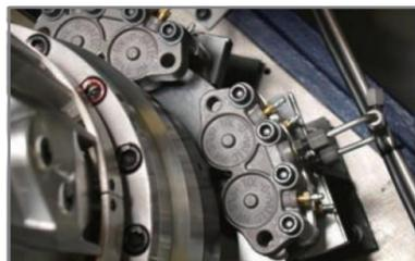
► Функция позиционирования оси шпинделя С использует поворотный энкодер с технологией многоточечного позиционирования для индексирования. Минимальная степень позиционирования составляет 0,001.
