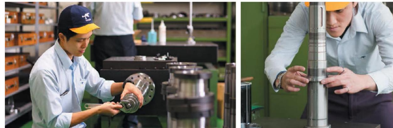
Для того чтобы достигнуть самых высоких стандартов качества ключевых компонентов, все блоки собраны в комнате температуры постоянного пребывания. Такие важные узлы, как шпиндели, редукторы и силовые башни, создаются опытными инженерами и проходят серию испытаний.
