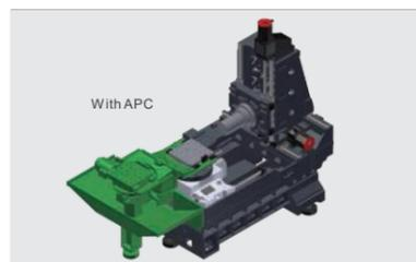
► Учитывая требования времени цикла и времени загрузки/разгрузки, APC доступен в качестве опции.
