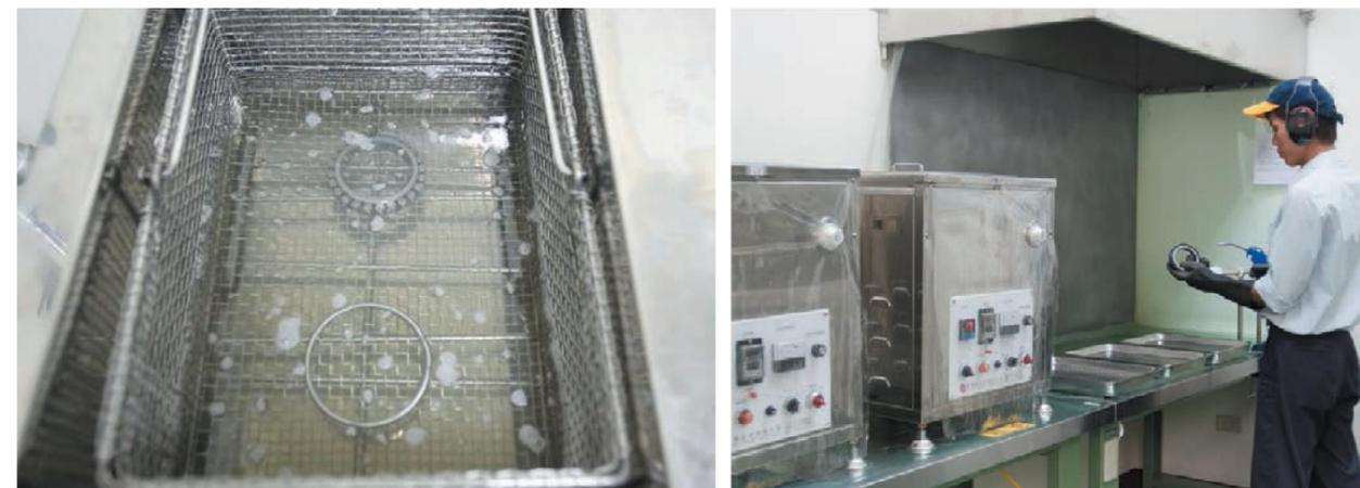
Кроме того, Тонгтай использует ультразвуковую очистительную машину для очистки подшипников. Благодаря передаче вибрации он создает «кавитационный эффект» и удаляет пятна на поверхности подшипников.
