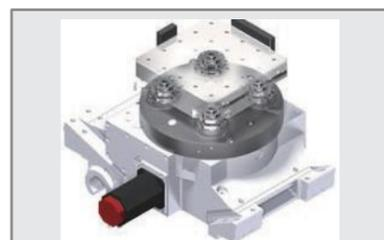
► Высокоточные конусы позиционирования с гидравлическим зажимным устройством, которые генерируют 4,2 тонны зажимного усилия для обеспечения стабильности стола при обработке.
