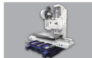
► 3-оси с коробчатой, термообработанной и шлифованной конструкцией. Это соответствует требованиям сверхмощной резки и высокой жесткости.
