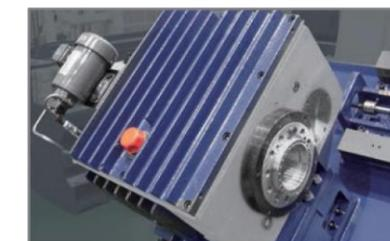
► Двухступенчатая коробка передач обеспечивает высокий крутящий момент на низких оборотах.
