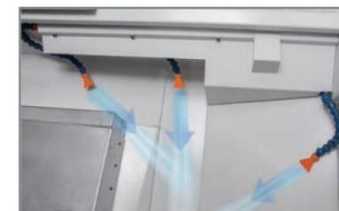
▶ 1.3 Система промойки станины машины мощностью 1,3 кВт позволяет избежать скопления стружки в машине.
