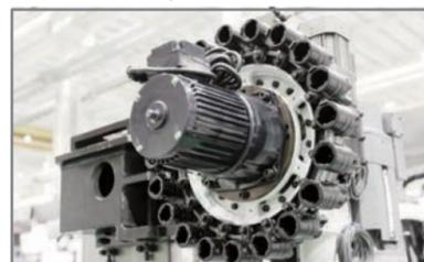
▶ АТС приводится в движение роликовым механизмом. Благодаря ослаблению инструмента синхронизированное вращение сменщика инструмента обеспечивает высокую скорость и стабильную замену инструмента. Кроме того, благодаря функции предустановки инструмента он экономит время простоя и повышает эффективность производства.
