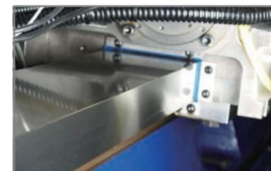
► Три оси спроектированы с коробчатой структурой и подвергаются надлежащей термообработки и процессу шлифования, чтобы удовлетворить требования к высокой жесткости при тяжелом или прерывистом резании.
