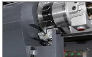
▶ Основные части станка сделаны из высокоуровневого отлитого железа. Это позволяет станку поглощать вибрацию и минимизировать деформации. Кроме того, конструкция машины оптимизирована с помощью анализа методом конечных элементов (FEA). Это гарантирует, что машина отличается высокой динамической жесткостью и стабильностью при высокоскоростной обработке.
