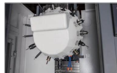
▶ Инструментальный набор типа А приводится в движение высокоскоростным серводвигателем со скоростью индексирования всего 0,2 сек.
