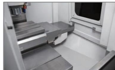
▶ Наклонная конструкция станины из листового металла с промойкой охлаждающей жидкостью обеспечивает легкий вывод стружки из станка.
