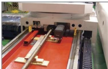
▶ Три оси с роликовыми линейными направляющими с характеристиками высокой жесткости и низкого трения. Быстрый ход 25м/мин.
