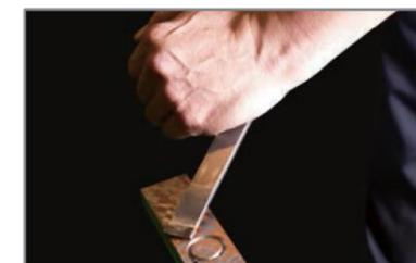
► Для обеспечения наилучшего качества сопряжения все коробчатые секции проходят тщательную операцию шабрения опытными специалистами. Это также позволяет избежать тепловых искажений станков и сохраняет качество обработки при тяжелых условиях обработки.
