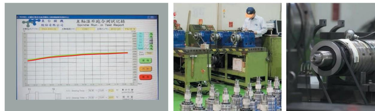
Модуль контроля температуры обкатки шпинделя управляет смазкой для хорошего распределения на подшипниках шпинделя, он обеспечивает рабочие характеристики шпинделя и продлевает срок службы шпинделя. Кроме того, каждый шпиндель должен пройти испытание на динамическое равновесие, что помогает поддерживать высокие характеристики и высокую точность во время высокоскоростного движения.
