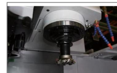
► Для ограничения тепловых воздействий от редуктора подшипники шпинделя смазываются консистентной смазкой, а шпиндель закрывается охлаждающей втулкой. Это устраняет тепловые искажения и продлевает срок службы.
