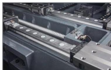
► Высокоточные направляющие 45мм по всем трем осям, данные направляющие повышают жесткость на 40% по сравнению с ШВП
