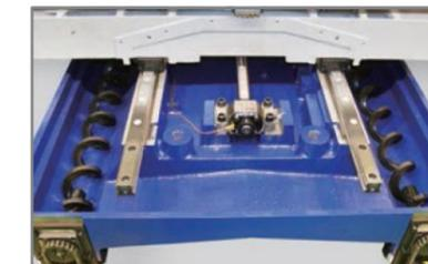
▶ Система промывки станины станка способна устранить скопление стружки в машине. Кроме того, двойные шнеки для стружки-это вариант с преимуществами быстрой утилизации стружки и минимизированным временем очистки.
