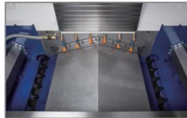
Двойные шнеки со стружкой и системой промывки станины станка позволяют быстро удалять стружку.
