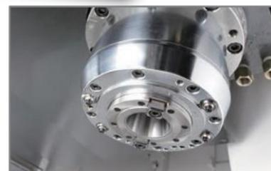
► Подшипник шпинделя смазывается маслом-воздухом, а шпиндель покрывается охлаждающей втулкой, что устраняет тепловые искажения и продлевает срок службы.
