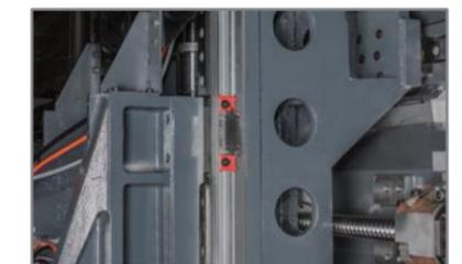
► Станок оснащен линейными шкалами по трем осям. Он обнаружит изменение температуры ШВП и компенсирует ошибки позиционирования и повторяемости. Стандартная точность позиционирования составляет ±5 мкм и ±3 мкм (опц.), а разрешение инкодера оси A/C-2 мкм и 5 мкм.
