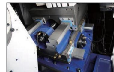
▶ Обе оси X и Z спроектированы с коробчатой структурой с надлежащей термообработкой и процессом шлифования. Эти детали удовлетворяют требованиям высокой жесткости при интенсивной или прерывистой резке.
