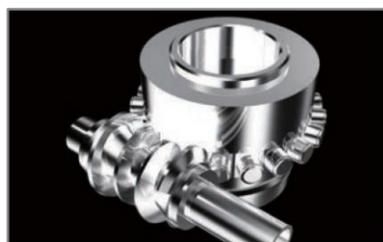
► Поворотный стол оси В приводится в движение кулачком шестерни ролика с низким крутящим моментом, подходящим для высокоскоростного вращения при сохранении долгосрочной точности обработки.
