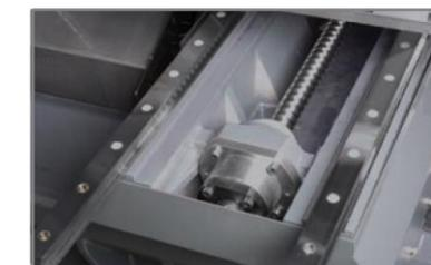
► ШВП с предварительным натягом для устранения влияния тепловых искажений и повышения точности обработки.
