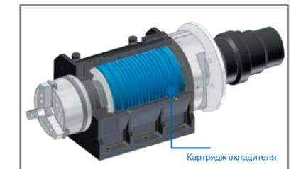
► Встроенный шпиндель оснащен системой охлаждения для контроля температуры и минимизации термической деформации при длительной механической обработке.
