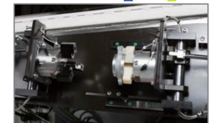
▶ Манипулятор робота способен обрабатывать движение по трем осям. Управляемый серводвигателем, программируемый манипулятор робота способен учитывать быструю скорость подачи и различные формы заготовки для регулировки точек позиционирования.
