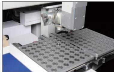
▶ Учитывая разнообразие заготовок, можно выбрать различные решения для хранения заготовок.
