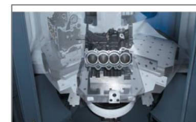
► Оптимизированный гидравлический привод APC не только улучшает динамическую жесткость, но и сокращает время смены поддона даже при максимальном весе на обоих поддонах.
