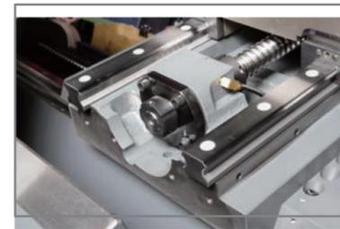
▶ Ось X, и Y-оси с линейными направляющими и ШВП для обеспечения качественного высокоскоростного резания, они отличаются высокой жесткостью, низким трением и шумом.
