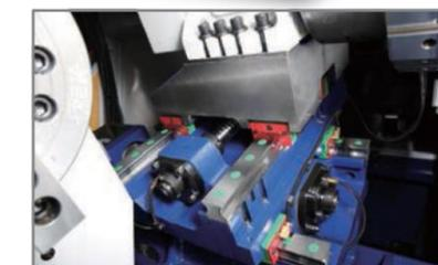
▶ Линейный направляющий путь доступен с более высокой быстрой траверсой (30 м/мин). Такая скорость экономит время без резки и повышает производительность.
