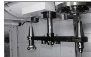
АТС использует блок смены инструмента кулачкового типа. Это дает характеристики высокой точности, малолумного и стабильного зажима инструмента, а также преимущества точности шпинделя и срока службы использования.
